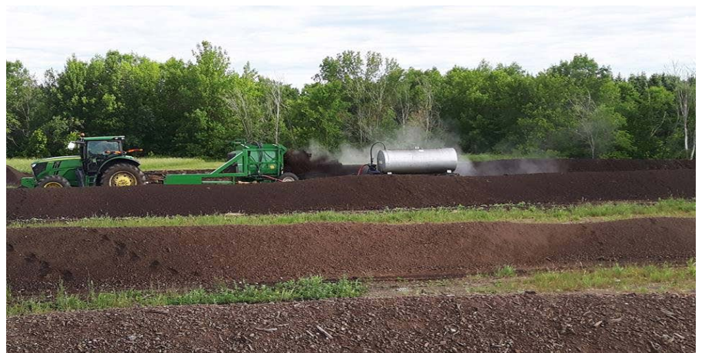
Machinerie conçue par M. Beauchesne pour retourner et arroser les amas de matières organiques sur le site de compostage à Saint-Isidore dans l'Est ontarien.
